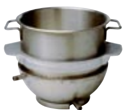
Perol doble pared no. 18 para agua/vapor (max. 1/2 atm.) para calentamiento o enfriamiento del contenido del perol.
