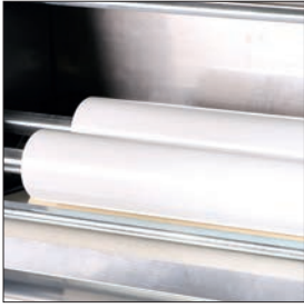
Tres rodillos de laminación en polietileno alimentario
